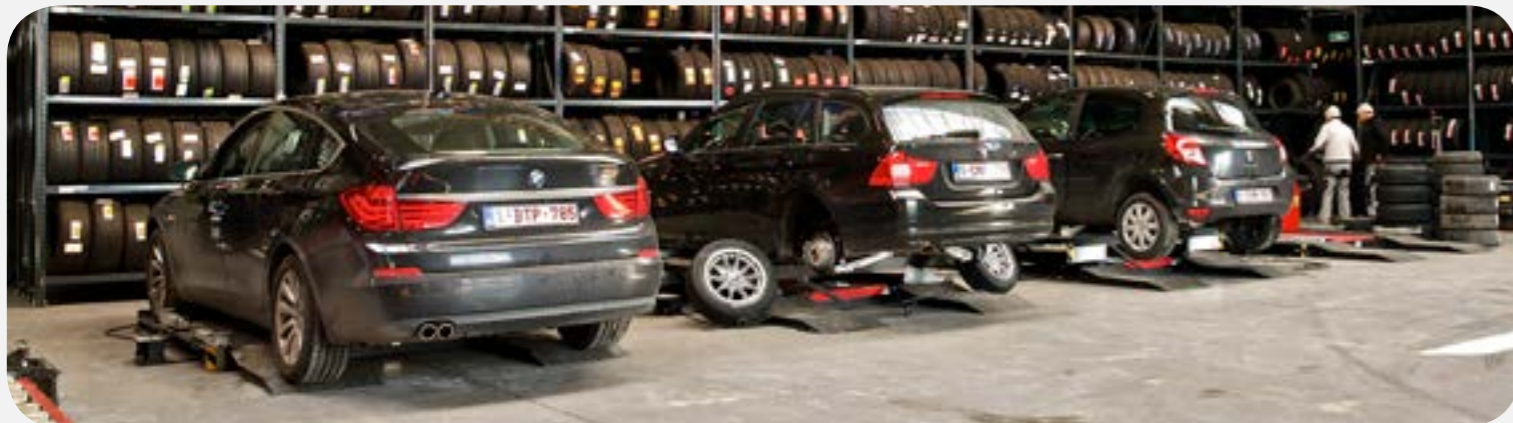
Erco-25S hefbruggen met opritten/stopblokken + zwenkarmen bij Espace Pneus te Braine l'Alleud.
