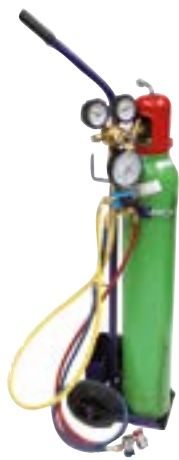
Dichtheidstest via stikstofdruk
